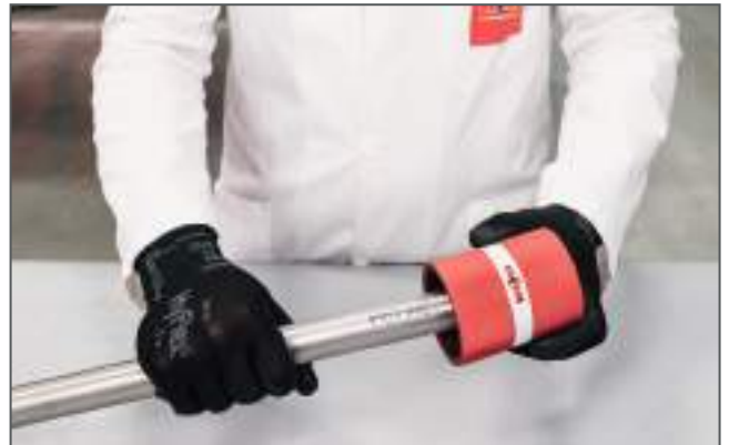
Sbavatura del tubo / Deburring the pipe
